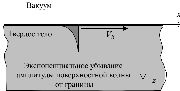
Рис.4.7. Зависимость амплитуды поверхностной волны вблизи границы раздела сред
