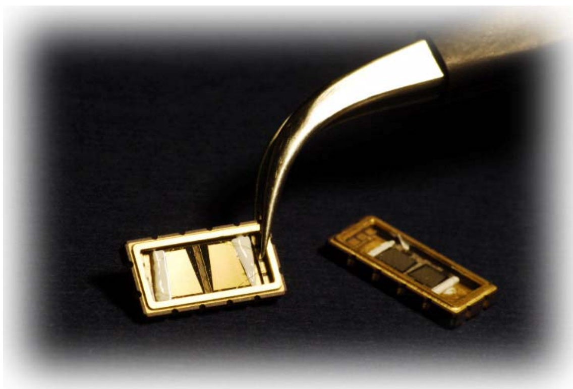
Рисунок 34 – Фото квазивеерных фильтров на ПАВ на базе ОФНП фильтров в металло-керамическом SMD корпусе 13,3 x 6,5 мм (не закрытые, фильтр ФП-473 (слева) удерживается пинцетом).
