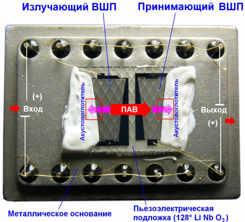
Рисунок 32 – Схема распространения основной и поглощения паразитных ПАВ (Фото фильтра ФП-474 70В38v1 D в корпусе DIP 151.15-8 19,5×14,5 мм с нанесённым акустопоглотителем).
