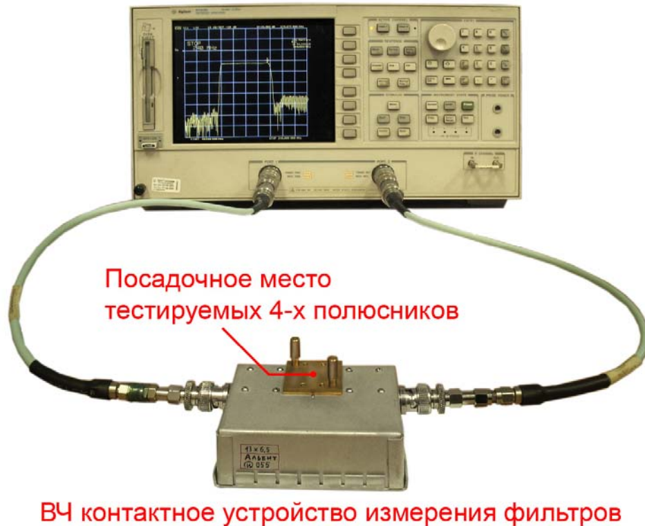
Рисунок 6 – Общий вид измерительной системы (герметизированные фильтры на ПАВ размещаются в специальном посадочном месте ВЧ контактного устройства)
